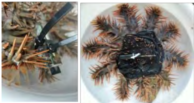
写真1. ロガーの装着方法
