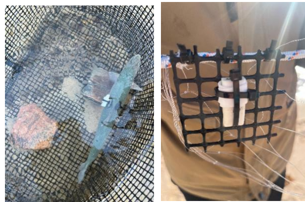
図 5. ホッキョクイワナに取り付けたロガー(左), 刺網に取り付けたロガー(右)
