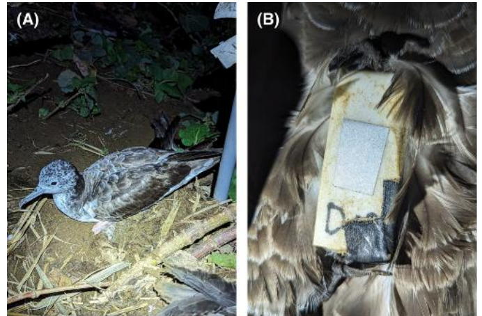
図 1. (A) オオミズナギドリ ( Calonectris leucomelas ) の成鳥 (B) 背中の羽毛に装着されたデータロガー (Axy-Trek)
